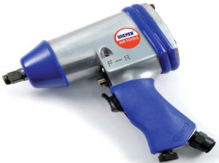
16243 Llave de impacto 1/2" BREMEN Consumo de aire: 4 cfm Velocidad: 7000 RPM Torque máximo: 312 nm Embrague: Oscilante / Seguro Largo: 180 mm / Peso 2,18 Kgs. Presión de aire: 90 psi / Conector 1/4"
