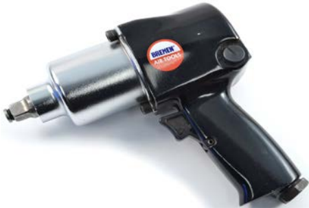
16251 Llave de impacto 1/2" uso intensivo Mecanismo doble golpe Escape de aire: Frontal Consumo de aire: 4 cfm Rango de Torque: 35-542 nm Capacidad de bulón: 5/8-M16 Velocidad: 8000 RPM Embrague: Oscilante / Seguro Largo: 187 mm / Peso: 2,6 Kgs. Presión de aire: 90 psi / Conector 1/4"
