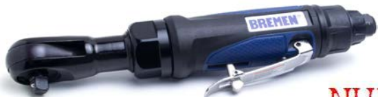
16233 Llave críque neumática encastre 1/4" Consumo de aire: 5.0 cfm Torque máximo: 21,7 Nm Velocidad: 265 RPM Largo: 151 mm / Peso 0,56 Kgs. Presión de aire: 90 psi / Conector 1/4"
