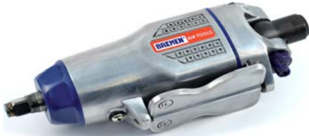
16246 Llave de impacto tipo mariposa Torque 129 NM Velocidad 10000 RPM Presion de aire 90 PSI
